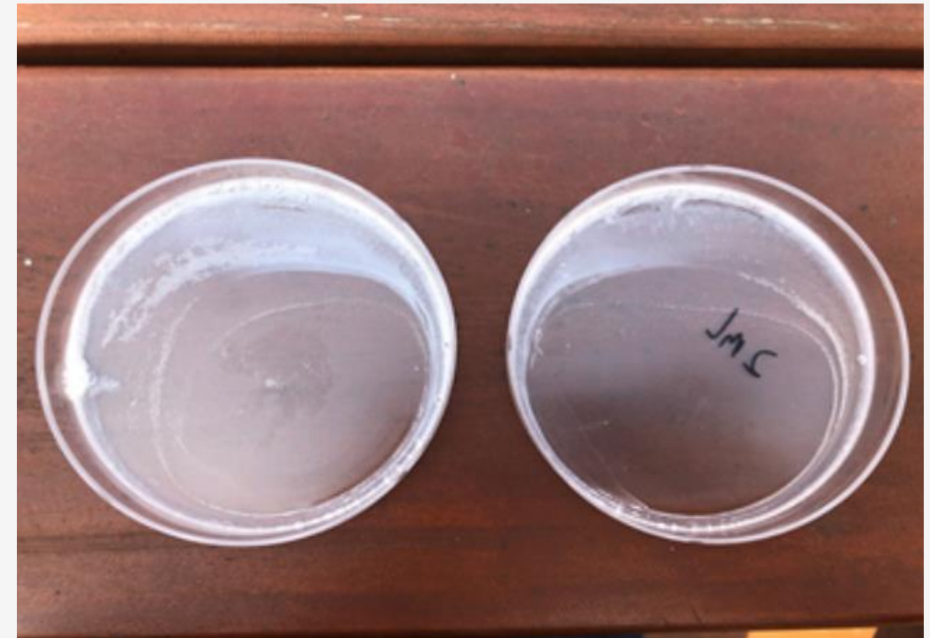
Surfactant 용액 건조를 통한 계면활성제 필름 제조
