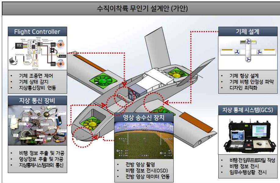
그림 1. 수직이착륙 무인기 설계안 및 구성요소 역할
